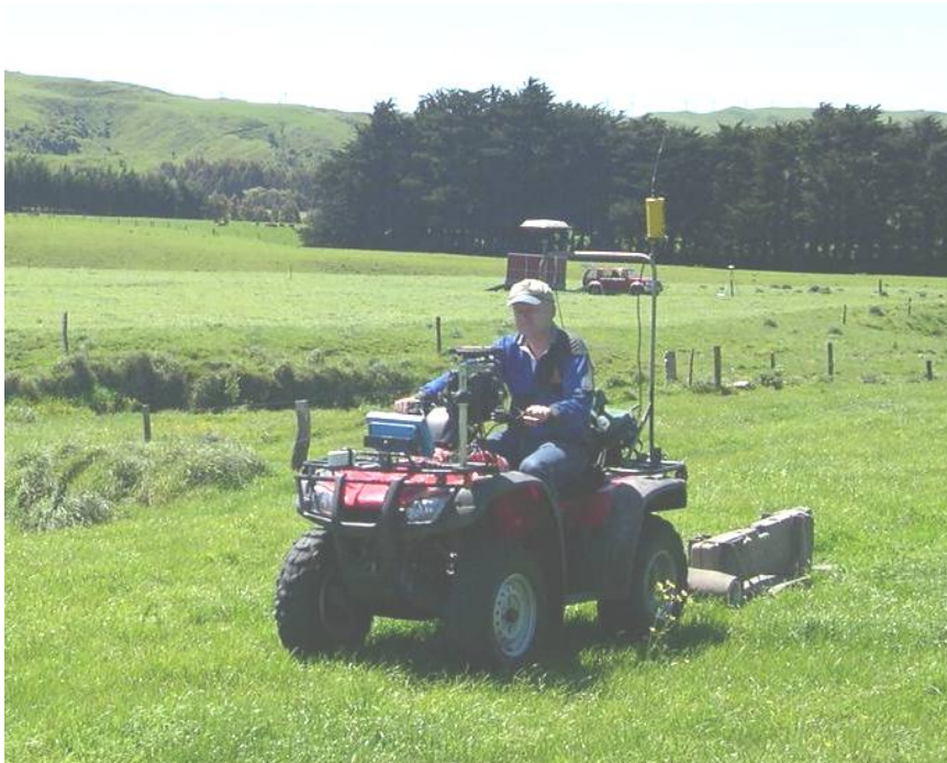
Fig. 1 On-the-go EM soil mapping system
